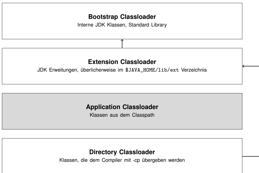
Figure 7: Die Classloader Hierarchie des „Java-TX Compiler“ ohne den ApplicationClassLoader
