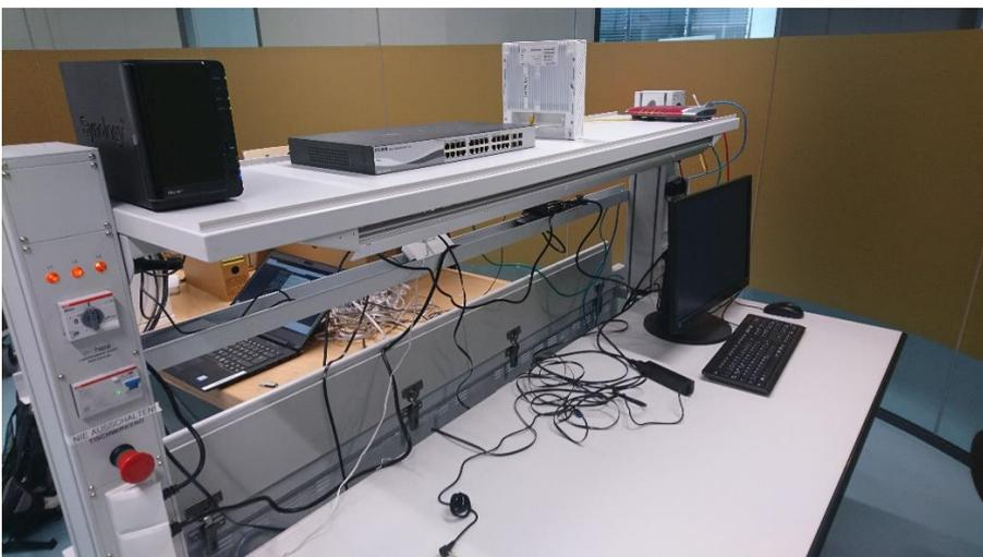
Abb. 2: Labortisch mit Notaus-Säule (links) und Server-Monitor/Tastatur rechts; NAS-Server, Switch, Lancom-AP und Fritzbox-Router oben
