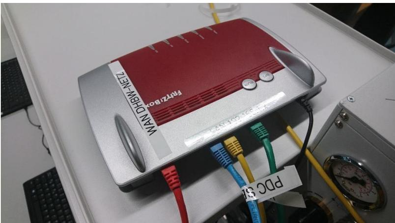
Abb. 7: Fritzbox-Router mit Ethernet-Verbindung ins WAN (Laptop-Netz der DHBW; rot) sowie LAN-Verbindung zum PDC-Server (blau) und Lancom-AP (gelb).
