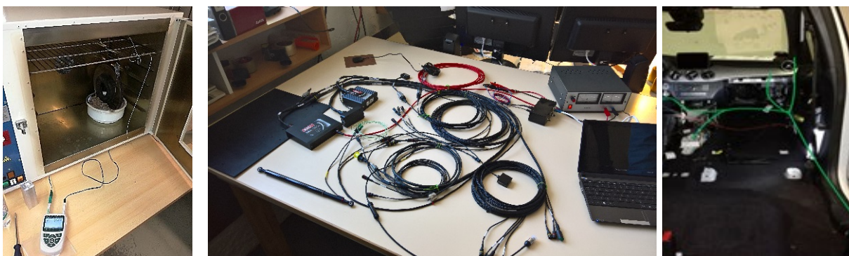
Abbildung 5: Kalibrierung der Sensorik — Kabelbaum-Check — Verlegen des kalibrierten Gesamtsystems im Fahrzeug, [7] und [8]
